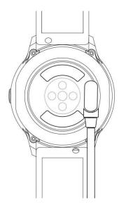
\* Tenha em conta que os dois contactos do cabo USB não podem entrar em contacto com o conductor ao mesmo tempo, pois provocará um curto-circuito.
